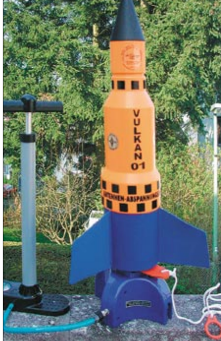
Die mit Wasser und Druckluft betriebene Rakete von H.-D. Traxel befördert zielgenau Antennenabspannungen in die Höhe.
