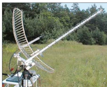
Bild 9: Typische S-Band-Antennen: BBQ-Spiegel und Helix mit 30 Windungen
