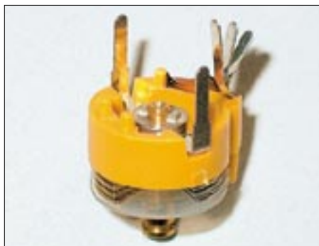
Bild 16: Alle Statorplättchen der Folientrimmer münden jeweils in einer eigenen Löt-fahne, was erst zu erkennen ist, wenn man das Beinchen vorsichtig aufspießt.
