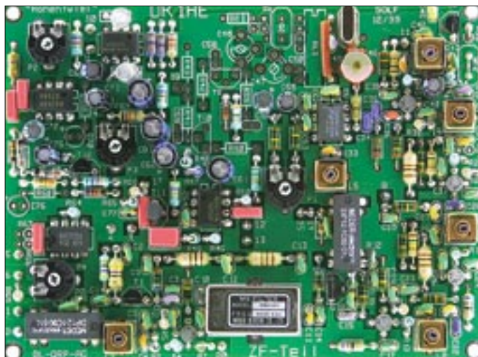
Bild 11: Gesamtansicht der ZF-Platine; am unteren Platinenrand etwa in der Mitte befindet sich das Quarzfilter. Eine ganze Reihe von Bauelementen, die für SSB-Betrieb erforderlich sind, entfällt bei der PSK31-Anwendung.
