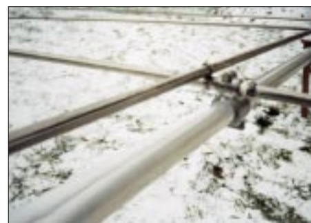
Bild 4: Befestigung eines Elements an den unterschiedlich starken Boomrohren
