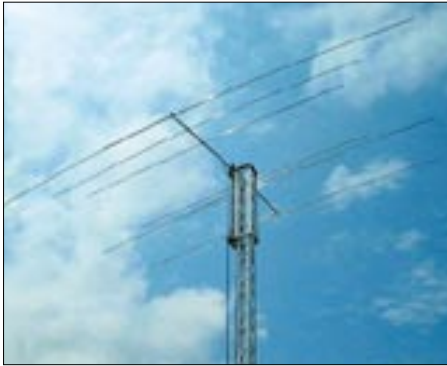
7-Element-Fünfbandbeam von Titanex mit neu entwickeltem Multiresonant-Open-Sleeve-Strahlersystem
