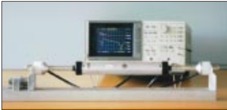
Professionalität durch und durch – hoFi demonstrierte am Stand die Durchlaßkurven der Fritzel-Sperrkreise auf einem kommerziellen Meßplatz
