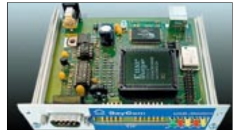
Dank Flexnet32-Treibern für Windows (≥ 98)-Betrieb gerüstet: USB-Packet-Radio-Modem für 1K2 bis 307 kBit/s von Baycom
