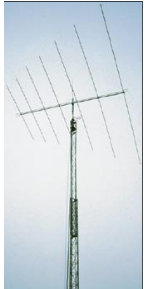
Bild 7: Ein imposanter Anblick: die 6 m x 11 m große LP7 auf dem 17 m hohen Mast
