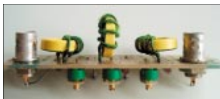
Bild 15: Probeaufbau eines 20-m-Bandpaßfilters auf einer kleinen Streifenleiterplatte zu Meßzwecken; die Spulen sind mit Amidonkernen T68 aufgebaut.
